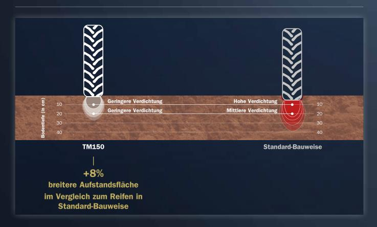
Je größer die Bodentiefe, desto höher ist im Vergleich die Verdichtung durch einen Reifen in Standard-Bauweise. In 20 cm Tiefe ist die Bodenverdichtung durch den TM150 noch "gering", während der Reifen in Standard-Bauweise in der gleichen Tiefe den Boden schon "mittelgradig" verdichtet.
