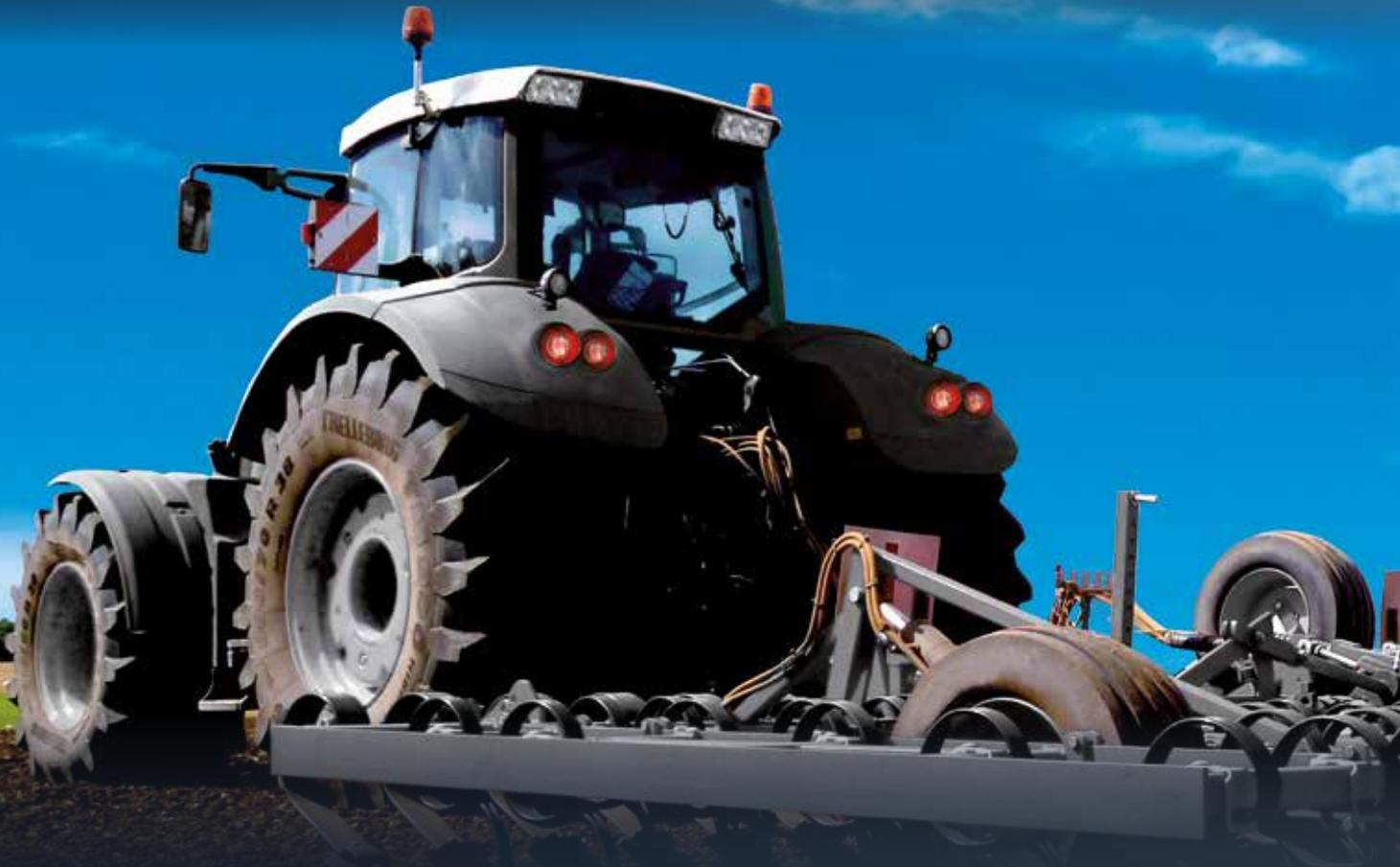
Der TM900 High Power für Traktoren von 250 bis 400 PS und Geschwindigkeiten bis 65 km/h\* wurde in Zusammenarbeit mit führenden Landmaschinen-Herstellern entwickelt. Er bietet eine unschlagbare Traktion und eine hervorragende Selbstreinigung, einen Fahrkomfort der Premiumklasse sowie ein erstklassiges Fahrzeug-Handling in Kombination mit einer Reduzierung der Bodenverdichtung und geringem Kraftstoffverbrauch.
