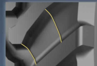
**2** Una banda de rodadura más plana mejora la huella del neumático y la estabilidad.
