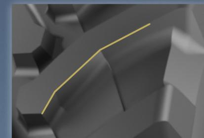
**5** Banda de rodadura de mayor anchura para aumentar la estabilidad y reducir el desgaste.
