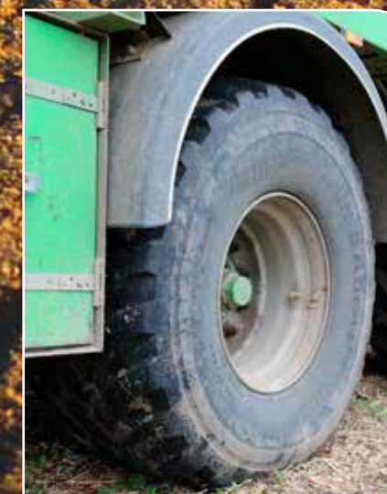
Spolvagnen har Trelleborg Twin Radial i dimensionen 560/60R22.5 monterade på axlarna. Den östjylländske entreprenören berömmar däcken för att ha bra bärformåga i våta marker, utmärkt självrensning och hög stabilitet på landsvägen.
